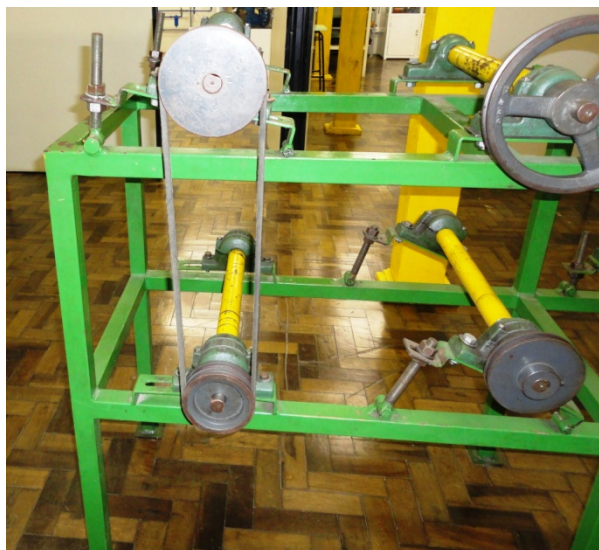
Fig. 6. Bancada de acionamentos mecânicos utilizada para realização do primeiro experimento.
