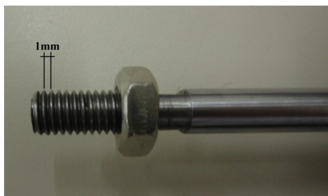
Fig. 4. Rosca na ponta da haste, referência para deslocamento.
